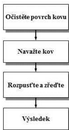
Obrázek 7.2. Příprava standardního roztoku kadmia
